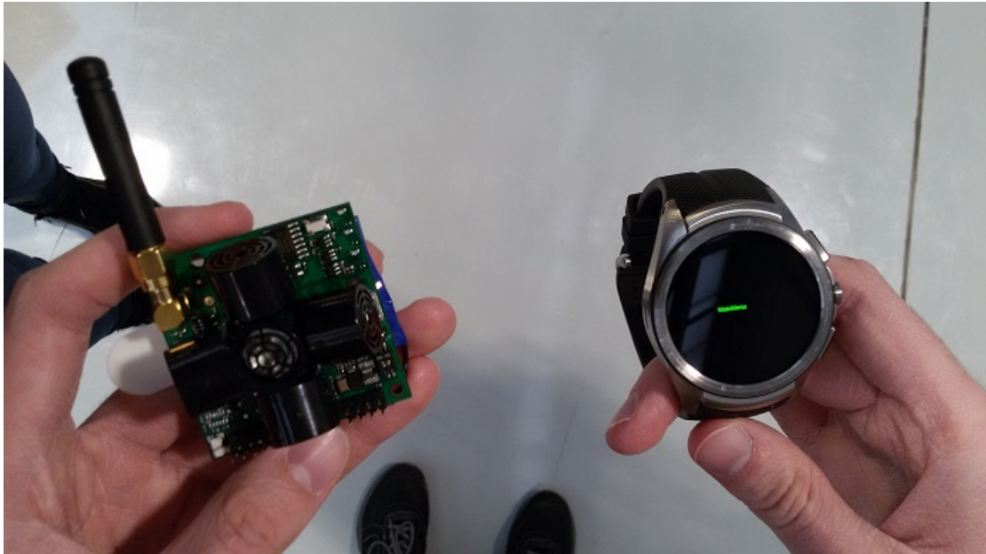
Abbildung 32: Marvelmind Empfänger (links) Smartwatch (rechts). Die Smartwatch verfügt über drei Alarmstufen, grün (im Bild) kein Alarm, gelb in einer Gefahrenzone und rot in einer kritischen Zone.
